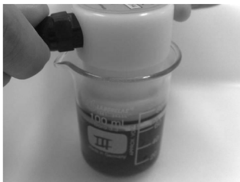
Figura 2. Aplicação do US estacionário subaquático. Copo de Becker contendo azul de metileno.
