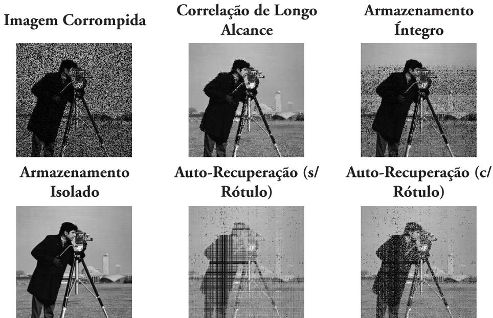
Figura 4. Comparação das técnicas aplicadas na imagem “Fotógrafo” corrompida com ruído do tipo pimenta com probabilidade 45%
