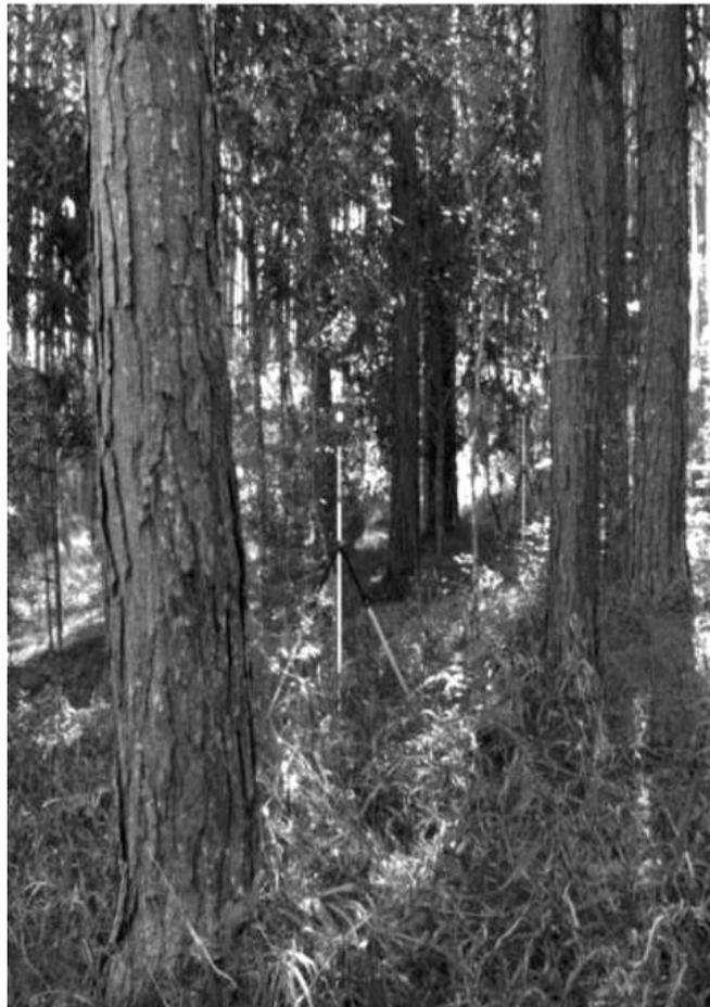
montada (Figura 2c), foram escolhidos dois pontos de posicionamento do *laser*, e em cada um deles realizou-se um giro de 360 graus com resoluções de 10 mm e 50 mm a 50 metros.
