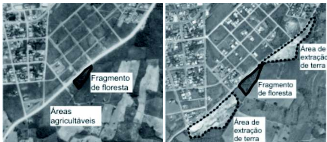
Figura 6. Fotografias aéreas mostrando as áreas de extração de terra (áreas de empréstimo)
