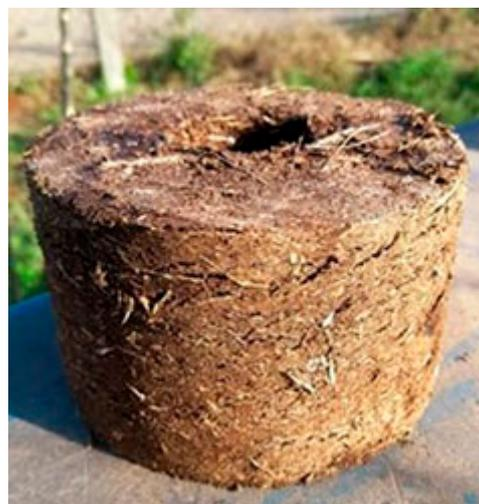
**Figura 1.** Briquete produzido com cama de aviário com adição de serragem
